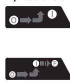
Schuif voor de **ingebruikname** van het elektrische gereedschap eerst de aan/uit-schakelaar (4) naar achter en druk vervolgens op de aan/uit-schakelaar (4).
